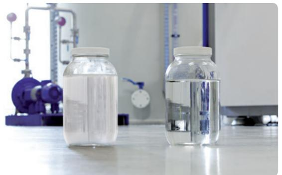
对传统真空蒸馏器所产生的蒸馏水与VACUDEST组合Clearcat所产生的蒸馏水进行外观比较后发现，先进的冷凝装置为处理后的工业废水质量树立了新的标杆。
